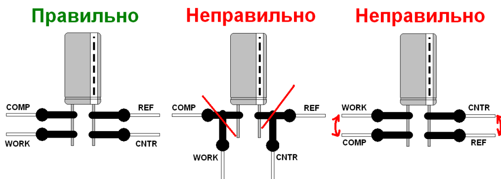
Рис. 7. Примеры приемлемых и ошибочных подключений низкоомных ячеек при отсутствии отдельных терминалов для силовых и потенциальных электродов.
