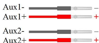
Рис. 4. Назначение выводов измерительного кабеля с зажимами типа крокодил для подключения электрохимической ячейки.
