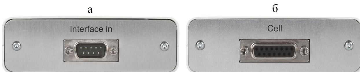
Рис. 2. Вид на предусилитель со стороны подключения шнура потенциостата – а, со стороны подключения ячейки – б.
