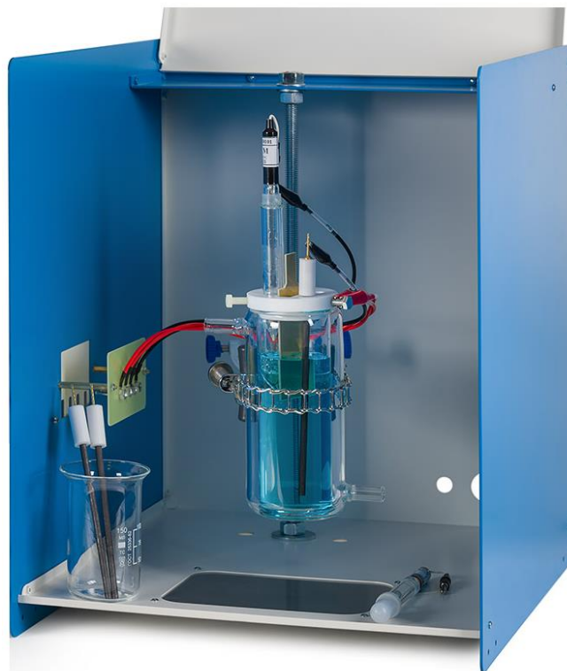
Рис. 7. Специализированный экранирующий шкаф Electrochemical Instruments с гибкими неэкранированными токоподводами, терминалом подключения прибора, алюминиевым окном в основании для магнитной мешалки, вводами для шлангов подачи газов и термостата.
