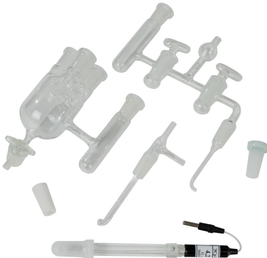
Рис. 3. Внешний вид основных компонентов электрохимической ячейки SC-1.
