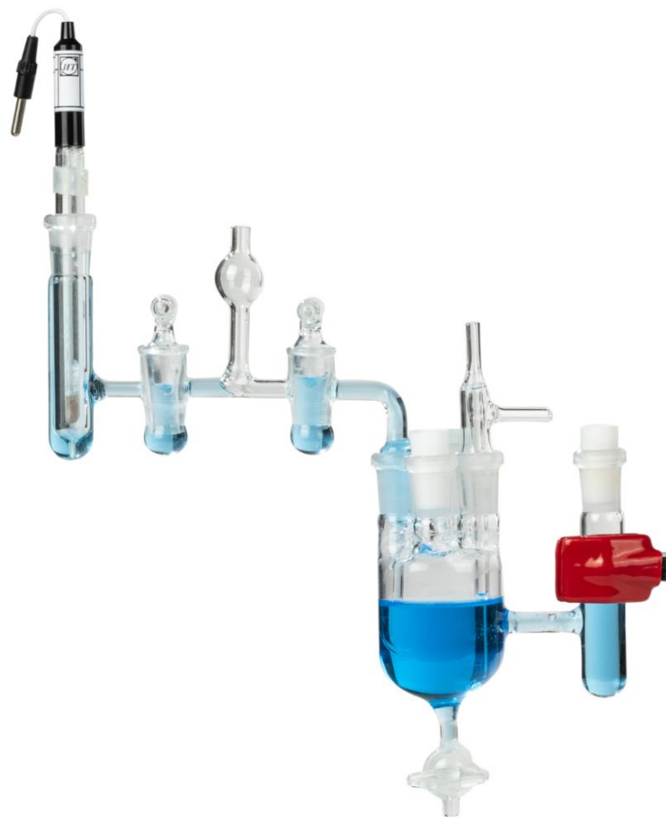
Рис. 1. Внешний вид собранной электрохимической ячейки SC-1.
