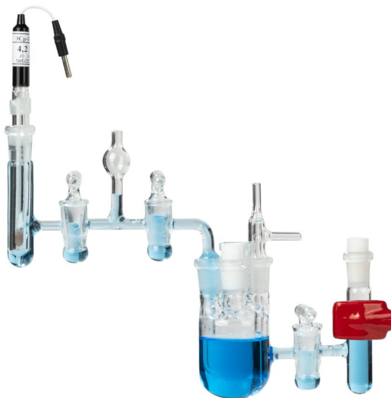
Рис. 2. Внешний вид собранной электрохимической ячейки SC-2.
