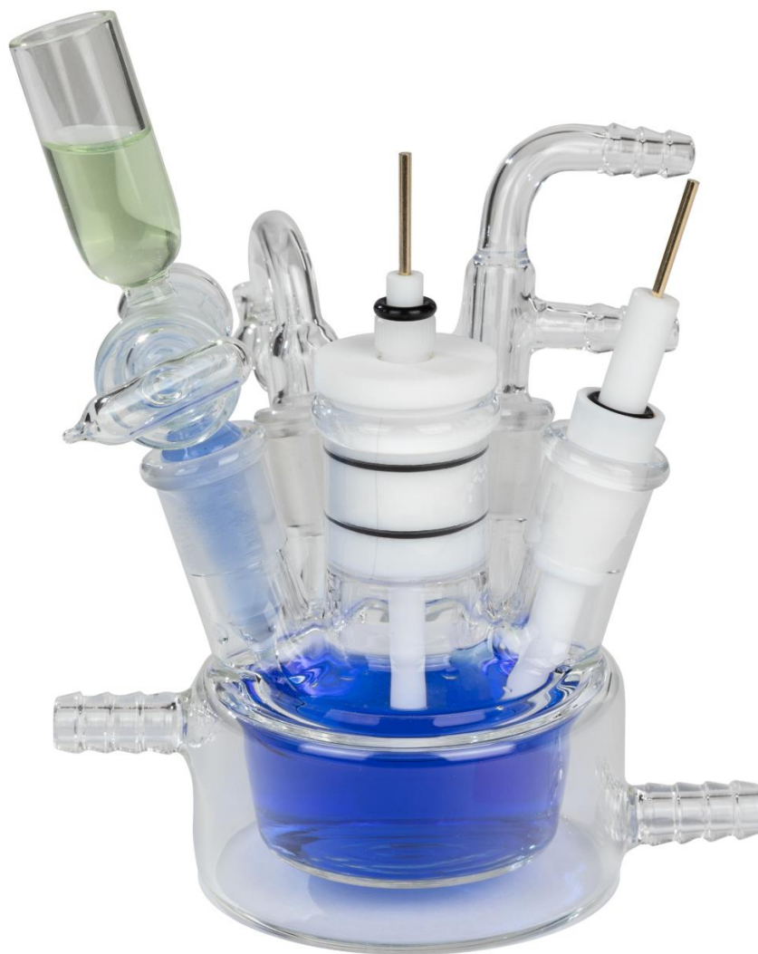
Рис. 5. Пример собранной ячейки SC-12 с платиновыми рабочим и вспомогательным электродами SmartStat (не входят в комплектацию).
