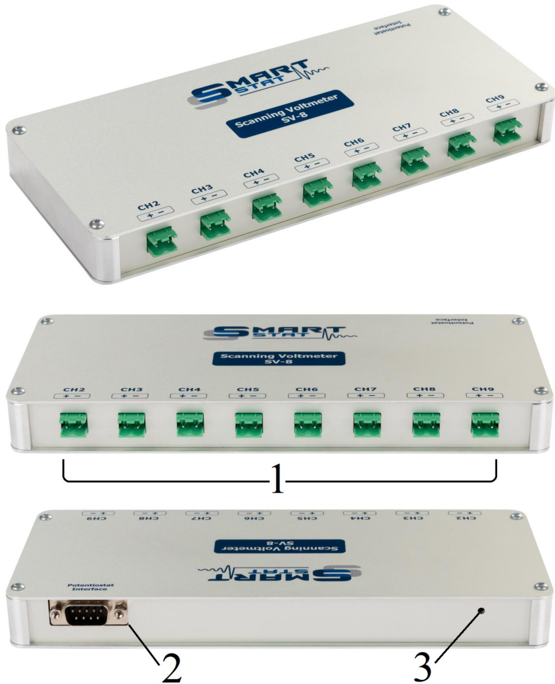
Рис. 1. Внешний вид сканирующего вольтметра SV-8 (1 - дифференциальные входы вольтметра 2-9, 2 - вход подключения цифрового интерфейса потенциостата, 3 - отверстие для вывода термопары).
