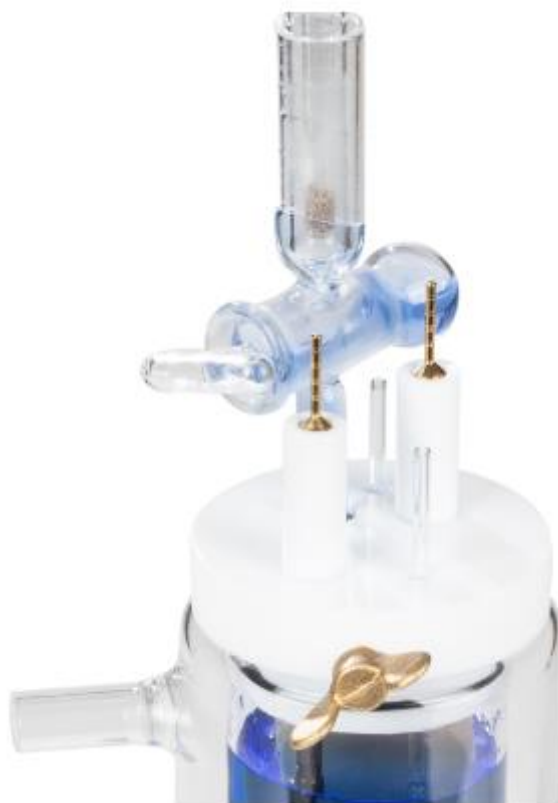
Рис. 4. Внешний вид герметичной фторопластовой крышки с разделенным мостиком электрода сравнения, двумя вспомогательными электродами (для поляризации рабочего электрода с обеих сторон), двумя трубками для продувки.
