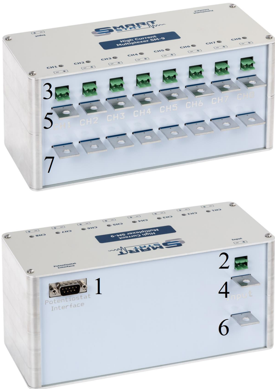
Рис. 3. Назначения входов и выходов мультимплексора SM-9 на его задней и передней панелях (1 - вход подключения управляющего цифрового интерфейса потенциостата, 2 - двойной вход подключения потенциальных выходов потенциостата, 3 - двойные выходы для подключения потенциальных проводов 8-ми переключаемых ячеек, 4 - положительный токовый вход подключения потенциостата, 5 - положительные токовые выходы подключения 8-ми ячеек, 6 - отрицательный токовый вход подключения потенциостата, 7 - отрицательные токовые выходы подключения 8-ми ячеек).
