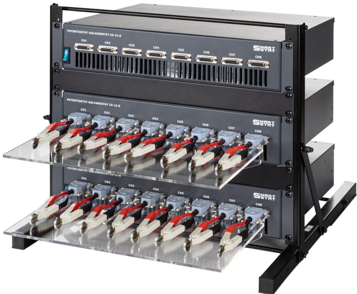
Пример установки аккумуляторов типа coin в держателях ВН-7. Потенциостаты CS-12-8 (1 А на канал) в настольной стойке.
