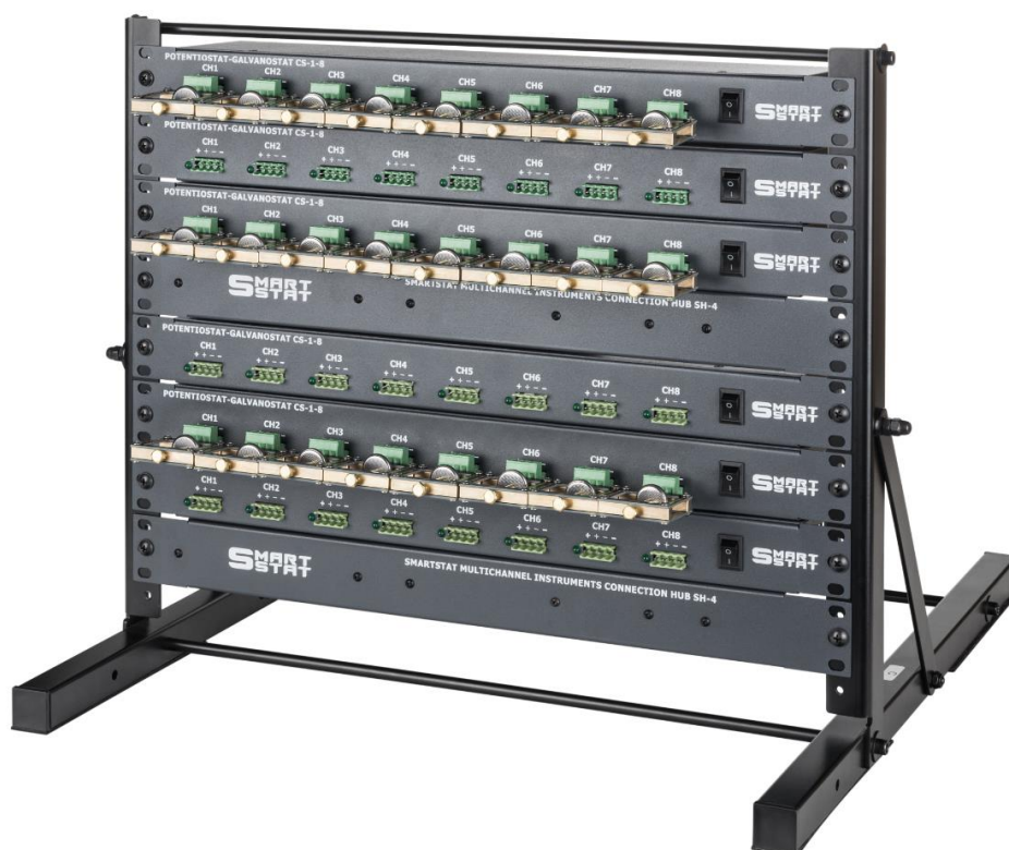
Пример установки большого числа держателей BH-18 с аккумуляторами типоразмера 2032 в разъемы 48-канальной тестовой станции на основе циклеров CS-1-8.
