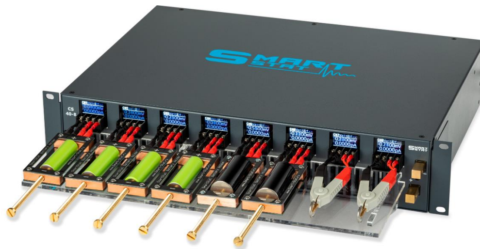
Пример установки полки ВН-10 на циклер CS-40-8.
