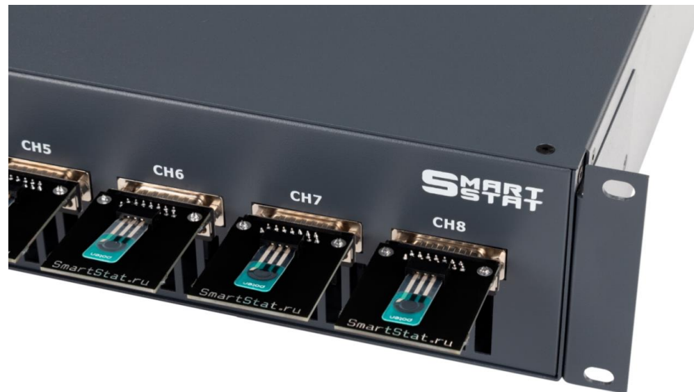
Пример установки держателей с разъемом DSUB-15 (ВН-9) в многоканальный потенциостат CS-12-8 (аналогично для PS-20-8)
