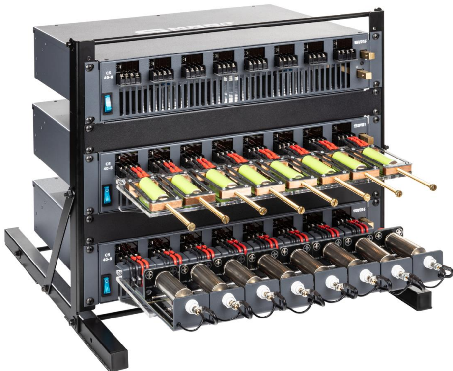
Пример установки цилиндрических аккумуляторов в четырехточечных держателях ВН-12 (снизу, металлические аккумуляторы 26650). Циклеры CS-40-8 (8 А на канал) в настольной стойке.
