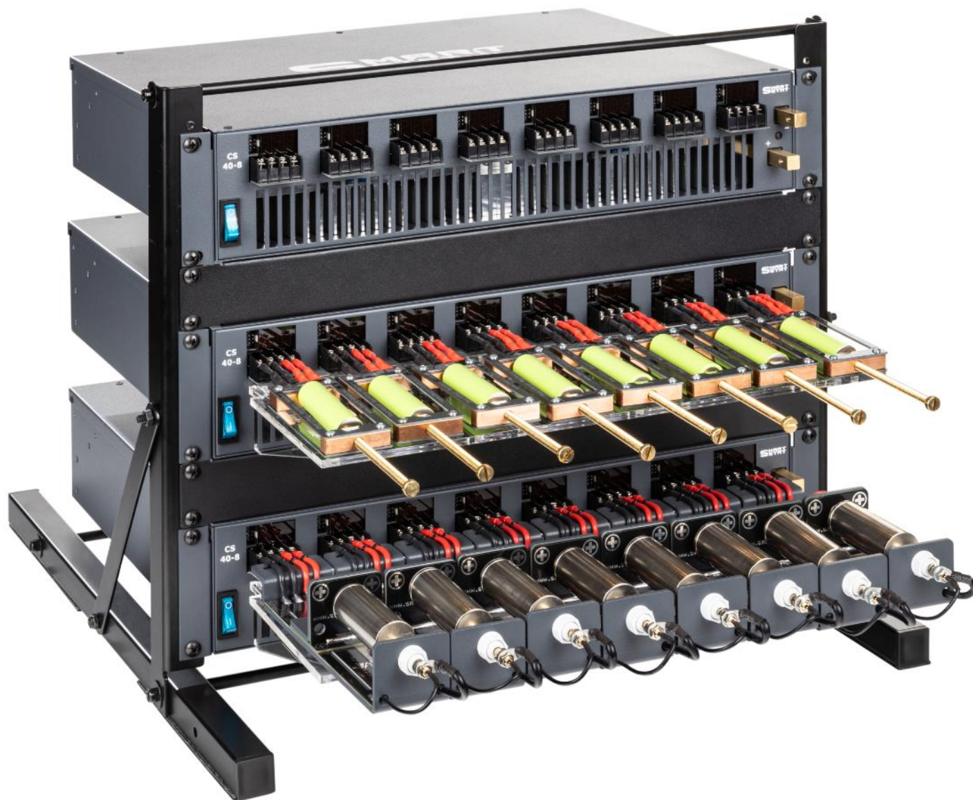
Пример установки цилиндрических аккумуляторов в двухточечных держателях VH-3 (сверху, зеленые аккумуляторы 18650). Циклеры CS-40-8 (8 А на канал) в настольной стойке.
